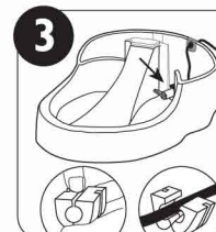
Stellen Sie die Pumpe anfangs gegen den Uhrzeigersinn auf die kleinste Stufe.
